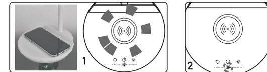
Hinweis: Verwenden Sie beim Aufladen über Qi keine Handyhüllen mit einer Dicke von mehr als 3 mm und keine Handyhüllen aus Metall. Aufladen über USB und Qi funktioniert nicht gleichzeitig.
